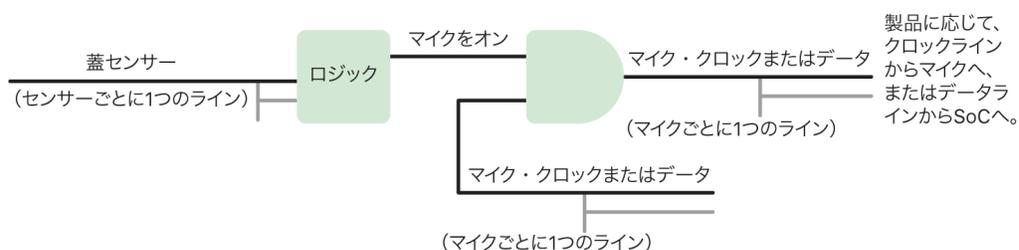
ハードウェアマイク切断機能がある各製品では、蓋やケースが物理的に閉じると、その作用の物理プロパティ(ホール効果センサーやヒンジ角度センサーなど)を使用して、蓋センサーがそれを検知します。校正が必要なセンサーでは、デバイスの生産中にパラメータが設定され、校正プロセス中にハードウェアが非可逆的にロックされ、その後センサーの重要パラメータはいかなる変更も不可能となります。これらのセンサーは、再プログラミング不可能なハードウェアロジックの単純なセットを通過する直接ハードウェア信号を放出します。このロジックにより、マイクを無効にする前に、デバウンス、ヒステリシス、最大500ミリ秒の遅延が提供されます。この信号を実装する方法は製品によって異なり、マイクとSystem on Chip (SoC) 間でデータを通信するラインを無効にする方法と、マイクモジュールを有効にする入力ラインの1つ(例えばクロックラインなどの有効なコントロール)を無効にする方法があります。
