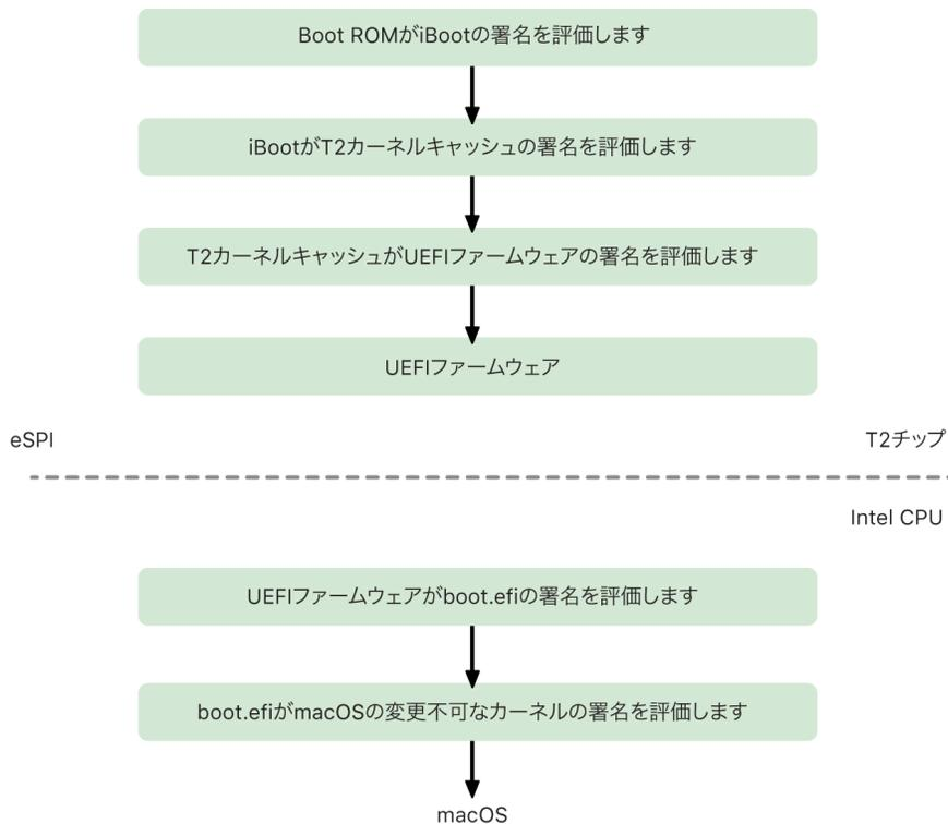
検証の後、UEFIファームウェアのイメージがT2チップのメモリの一部にマップされます。このメモリは、拡張シリアルペリフェラルインターフェイス (eSPI) を通じてIntel CPUで使用できるようになります。Intel CPUは自身の最初の起動時に、T2チップ上の、整合性が確認され、メモリにマップされたファームウェアのコピーから、eSPIを通じてUEFIファームウェアを取得します。
