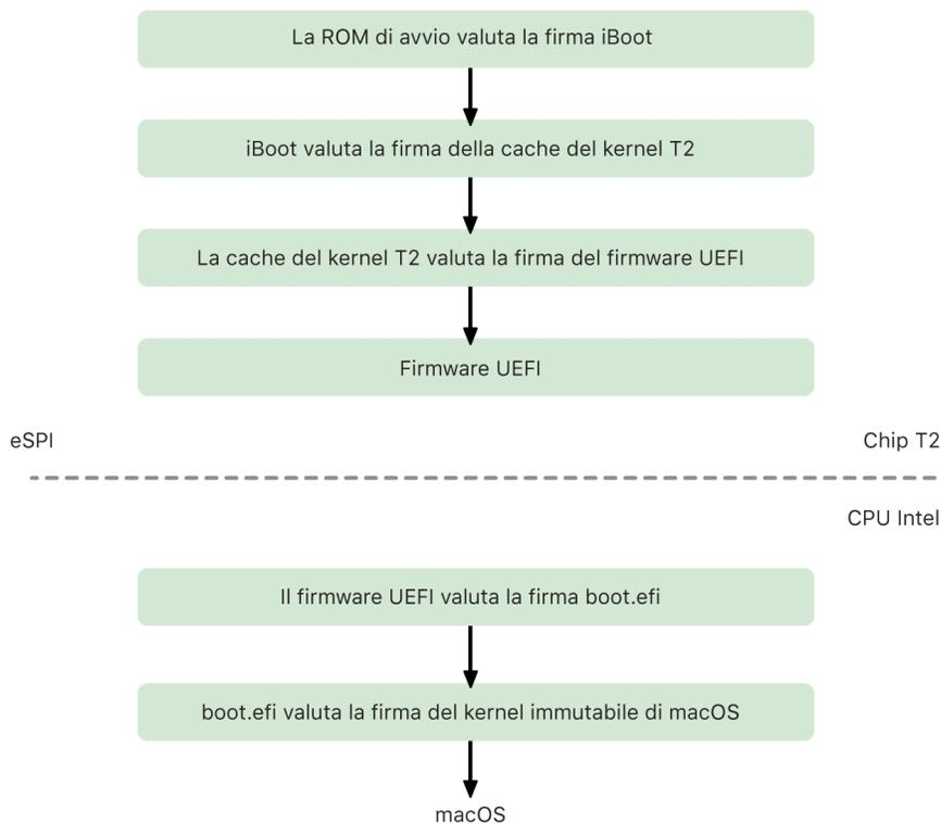
Dopo la verifica, l'immagine del firmware UEFI viene mappata in una parte della memoria del chip T2, che è resa disponibile alla CPU Intel tramite l'eSPI (enhanced Serial Peripheral Interface). Quando la CPU Intel si avvia per la prima volta, recupera il firmware UEFI tramite il protocollo eSPI dalla copia del firmware, mappata sulla memoria e di cui è stata previamente verificata l'integrità, situata nel chip T2.
