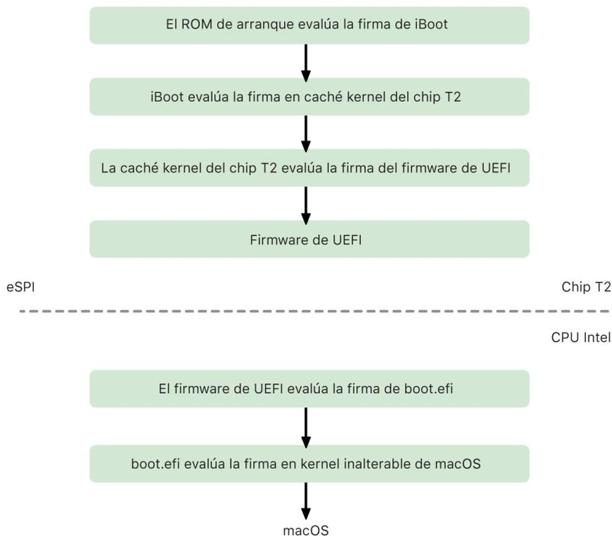
Después de la verificación, la imagen del firmware UEFI se asigna en una porción de la memoria del chip T2. Esta memoria se pone a disposición del CPU de Intel a través de la interfaz periférica serial mejorada (eSPI). Cuando el CPU de Intel arranca por primera vez, obtiene el firmware UEFI mediante la eSPI desde la copia asignada en la memoria y con verificación de integridad del firmware ubicado en el chip T2.
