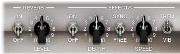
右側のスイッチを使って、トレモロ（「TREM」。サウンドの振幅または音量をモジュレート）またはビブラート（「VIB」。ピッチをモジュレート）のどちらか一方を選択できます。
