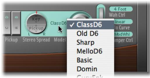
En algunos aspectos, se puede ver la elección de modelo como la selección de una onda de oscilador en un sintetizador. Como con las ondas de sintetizador puras, los parámetros de edición pueden afectar al modelo de formas muy distintas. Por ejemplo, utilizando ajustes de parámetros idénticos se puede conseguir que un modelo suene más nasal y otro más ruidoso.
