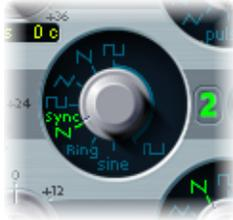
Cada vez que el oscilador 1 inicia una nueva fase de oscilación, el oscilador sincronizado (oscilador 2 o 3) también se ve forzado a reiniciar su fase desde el comienzo. Entre los ciclos de ondas del oscilador 1, los ciclos de ondas de los osciladores sincronizados se ejecutan libremente.
