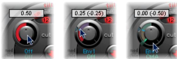
Si el corte se ajusta de nuevo en 0,50 y "Env 1" tiene ahora el valor en 0,25, el valor máximo de "Ctrl A" reduce la frecuencia de corte a 0.
