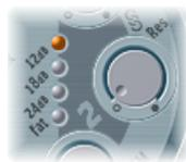
El filtro 2 ofrece tres pendientes diferentes: 12 dB, 18 dB y 24 dB por octava. Cuanto más inclinada sea la pendiente, más afectado se verá el nivel de las señales por debajo de la *frecuencia de corte* en cada octava.
