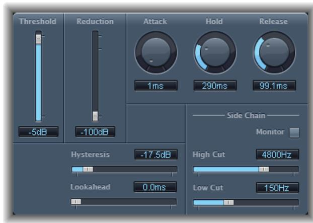
La figura anterior muestra un ajuste de Threshold adecuado para la comprensión del habla. Los filtros de cadena lateral asignados a las puertas de ruido evitan los accionamientos indeseados provocados por ruidos de frecuencias altas o bajas. Los valores de Hold, Release e Hysteresis son adecuados para la mayor parte de las señales de voces y habla.
