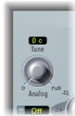
De forma parecida a los sintetizadores analógicos polifónicos, los tres osciladores mantienen su desviación de frecuencia específica entre ellos pero los tonos de los tres osciladores se desafinan aleatoriamente en la misma cantidad (Analog). Por ejemplo, si la desafinación de Analog se ajusta a aproximadamente un 20%, los tres osciladores (si se utilizan) caerán aleatoriamente un 20%.
