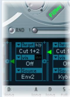
Configure un direccionamiento de modulación como el siguiente para establecer este tipo de modulación: ajuste el objetivo como “Cutoff 1”, “Cutoff 2”, o como “Cut 1+2”. Ajuste la fuente como ENV 2, por ejemplo. Una vez ajustado del modo indicado, el regulador de la derecha del direccionamiento de modulación funcionará como el parámetro EG Depth del filtro.
