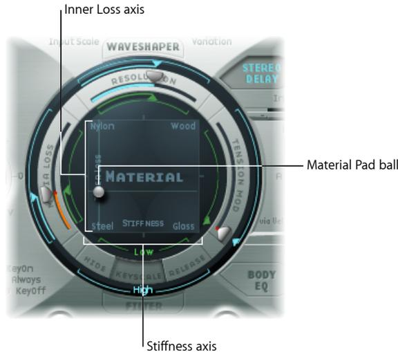
*Inner Loss* se utiliza para emular la amortiguación de la cuerda, mediante el material de la misma, acero, cristal, nailon o madera. Se trata de pérdidas que dependen de la frecuencia que hacen que el sonido se aprecie más suave durante la fase de caída.
