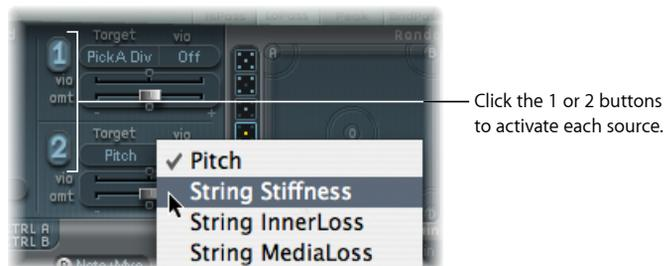
Los menús Via determinan la fuente que controla el escalado de modulación de cada LFO. En los casos en los que la fuente via se ajuste a Off, solo se mostrará un regulador de cantidad (el regulador “Via Amount” permanecerá oculto):
