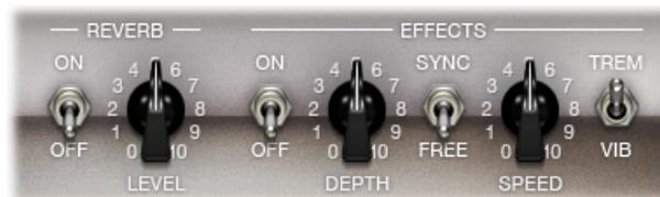
Puede utilizar el conmutador de la derecha para elegir Tremolo (TREM), que modula la amplitud o el volumen del sonido, o Vibrato (VIB), que modula la afinación.
