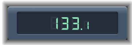
El indicador luminoso muestra el estado del análisis actual. Si el indicador luminoso parpadea, significa que se está realizando una medición del tempo. Cuando el análisis ha terminado, el indicador permanece iluminado y aparece el tempo. El intervalo de la medida oscila entre 80 y 160 tiempos por minuto. El valor medido se muestra con una precisión de una posición decimal. Haga clic en el indicador luminoso para reiniciar BPM Counter.
